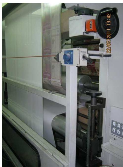
ภาพที่ 3.10 फिल्म PET กับ W-LLDPE ประกบเชื่อมกันด้วยเครื่องประกบ
