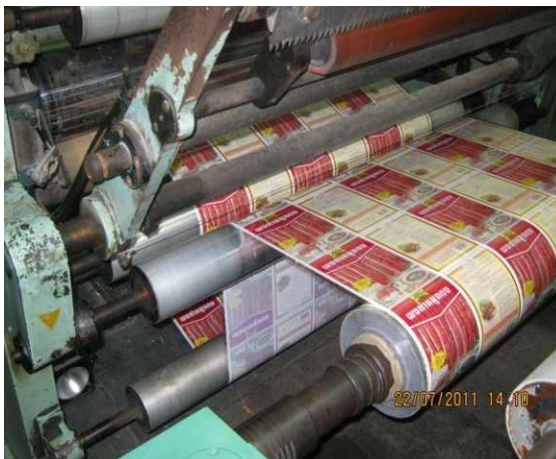
ภาพที่ 3.5 ผลิตภัณฑ์สำเร็จออกจากการพิมพ์กำลังม้วนเก็บเข้าที่
