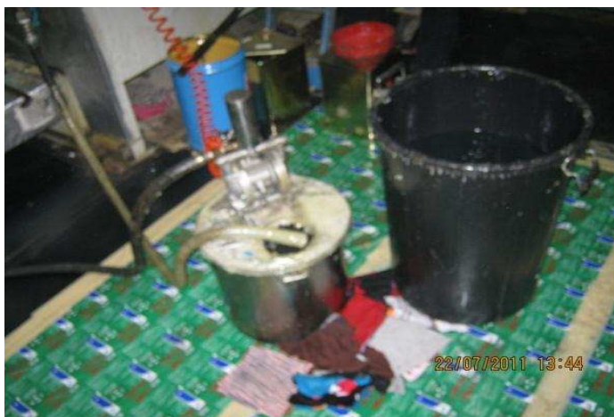
ภาพที่ 3.9 อุปกรณ์ผสมกาวยเข้ากับสารละลายลงถังสแตนเลส
