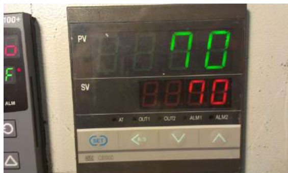
ภาพที่ 15 ชุดควบคุมอุณหภูมิ RKC รุ่น CB900 1/4 DIN Temperature Controllerw/ SSR output & Alarms
