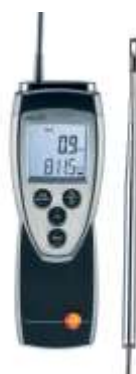
ภาพที่ 44 เครื่องวัดความเร็วลมและอุณหภูมิแบบดิจิทัล
