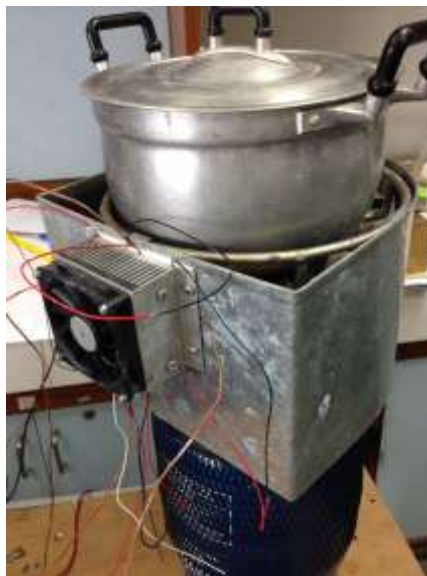
ภาพที่ 14 อุปกรณ์เครื่องแลกเปลี่ยนความร้อนสำหรับระบายความร้อนด้านเย็น บำรุงพันธ์ และเลิศสิทธิชนกร, 2557, น.564 (Bamroongkhan & Lertsatitthanakorn, 2014, p.564)
