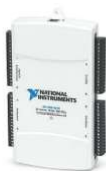
ภาพที่ 37 เครื่องบันทึกอุณหภูมิและแรงดันไฟฟ้า
