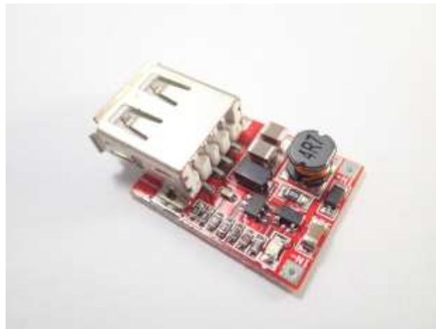
ภาพที่ 18 วงจรปรับแรงดันไฟฟ้าสำหรับชาร์จไฟผ่านพอร์ต USB
