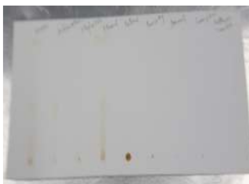
ภาพที่ 51 mobile phase ระบบที่ 13 อ่านผลด้วยตาเปล่า
