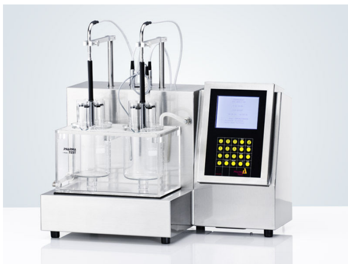
ภาพที่ 2.10 เครื่องวัดเวลาในการแตกตัวของยาเม็ด (disintegration apparatus)
