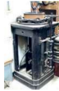
เครื่องตะเกียงที่ใช้ น้ำมัน จุด ไฟให้แสงสว่าง อยู่ในกรอบ แก้วเรือนตะเกียง
