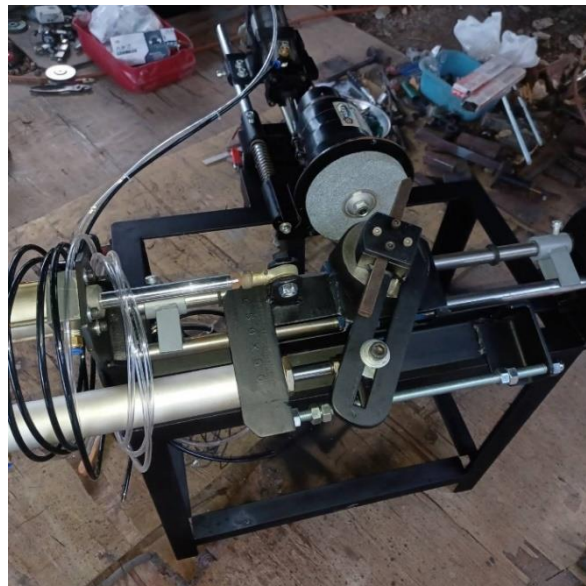
ภาพที่ 4.4 การร่างแบบการออกแบบและสร้างชุดลับมีดกลึง
