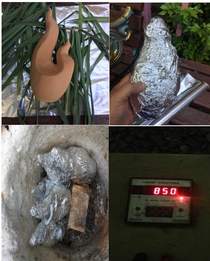
ภาพที่ 4.20 ขั้นตอนการเผาแบบไหม้แบบไม่สมบูรณ์ด้วยเทคนิคแซกการ ไฟริง ชิ้นที่ 1 ที่มา : กริช อนุกุล (2567)
